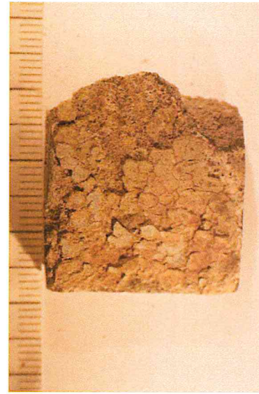
Próbka tynku ze szczątkowo zachowanymi warstwami malarskimi
